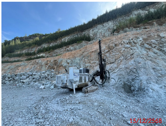
ภาพที่ 2-11 เครื่องเจาะรูระเบิดที่มีถุงพักฝุ่น
